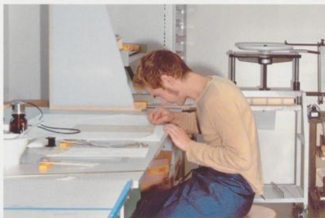
Abb. 24 Flicken von Rissen im Papier mit dem Heizkolben für Papierrestaurierung.
